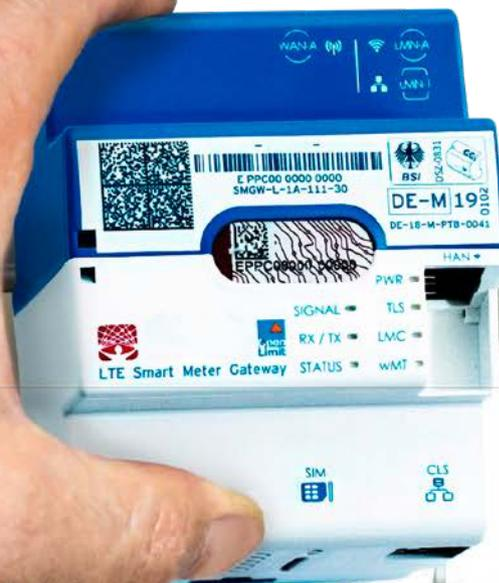
**Bei digitalen Stromzählern ist oft auch von moderner Messeinrichtung, intelligentem Messsystem oder Smart Meter die Rede. Was sind die Unterschiede?**
